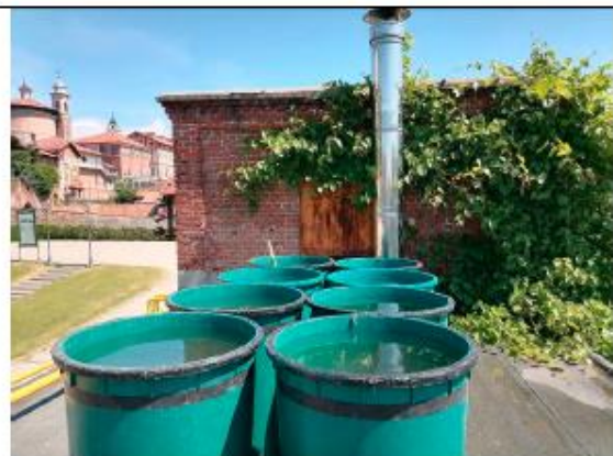
prova di carico su "solaio copertura piano terra, zona 1 (locale caldaia)"
