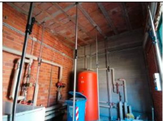
prova di carico su "solaio copertura piano terra, zona 1 (locale caldaia)"
