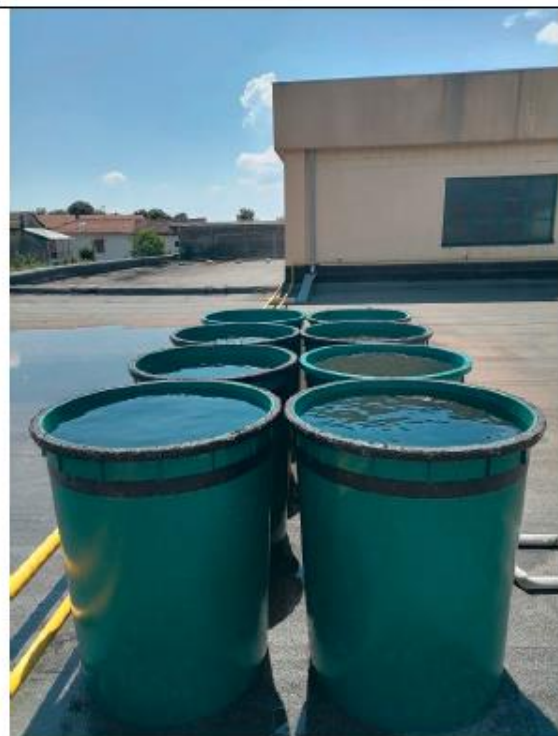
prova di carico su "solaio copertura piano terra, zona 2 (sala attività)"
